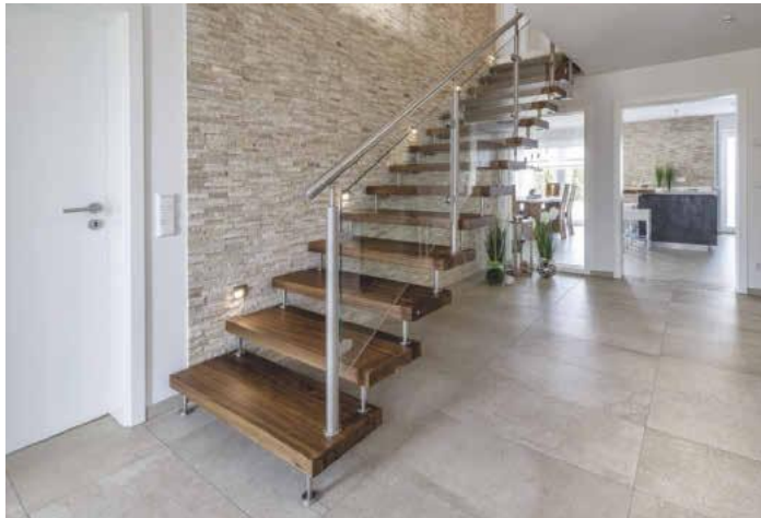
/ Treppenvielfalt: Frei tragende, geradläufige Kenngott-Treppe mit Massivholzstufen in Nussbaum und Terzo-Glasgeländer sowie Tragteilen in Edelstahl.
